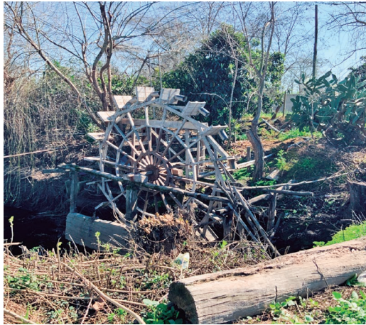
Rueda de Juan Arenas Valenzuela, de diámetro de 6 m, con 18 rayos, capachos de PVC 110 y bases mixtas de hormigón y madera.
