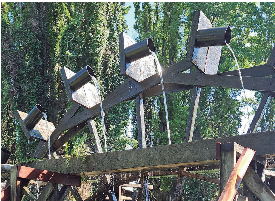
Vista de canoa recibiendo la descarga de agua de los capachos.
