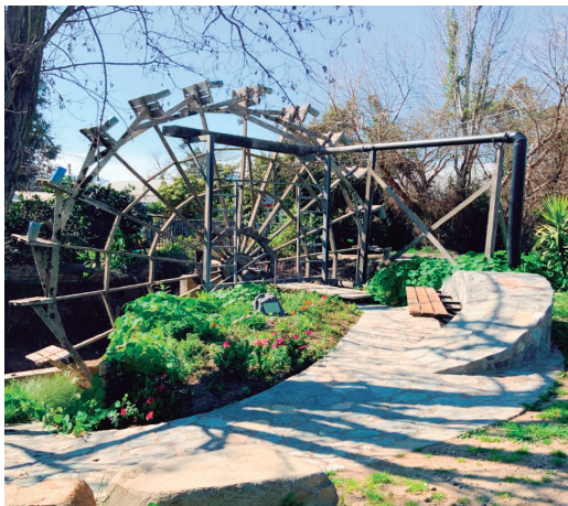
Rueda de José Arriaza, de diámetro de 8,8 m, con 22 rayos, capachos de PVC 110 y base de hormigón.
