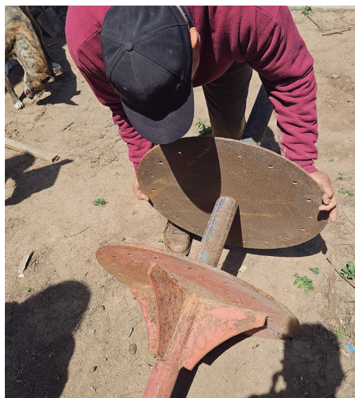
Vista de eje y masa con perforaciones.
