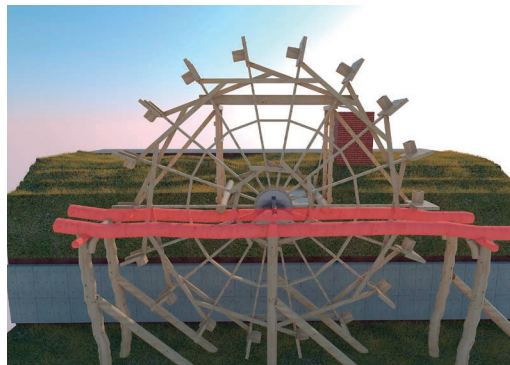
Identificación de vigas en rojo.
