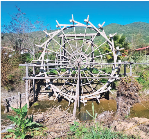
Rueda de Álvaro Toro Oyarzún, diámetro de 7 m, con 18 rayos, capachos de tarro de pintura y base de acacio.
