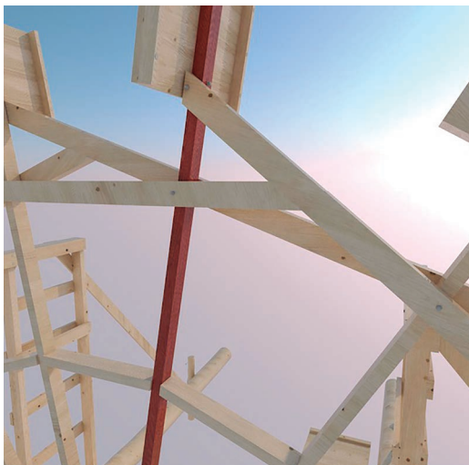
Vista de rayo reemplazado y traba en posición sin listón auxiliar.
