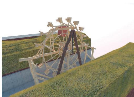
Levante del eje de rueda con estructura auxiliar (usando tecele) para cambio de viga.
